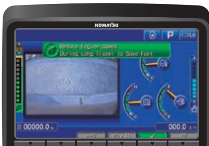
Eco-meter, eco-functie en brandstofmeter
