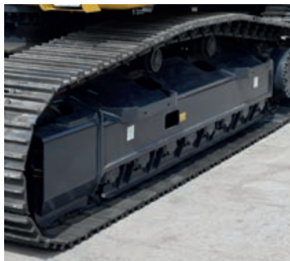
Onderrollen bescherming over de volledige rupslengte (optie)
