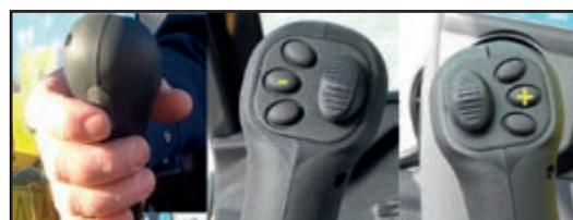
Commande sur le levier droit pour activer la fonction semi-automatique. Décalage altimétrique du projet via les commandes sur les leviers
