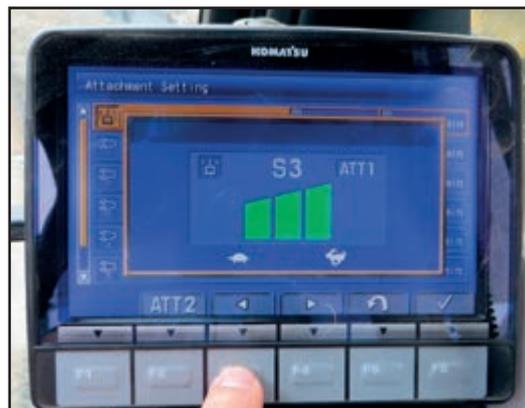
Pré réglage du débit hydraulique pour une inclinaison précise du godet. La ligne HCU A est utilisée pour cette fonction.
