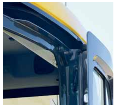
De schuifdeur vergemakkelijkt de toegang in beperkte ruimtes en vermindert het risico op schade tijdens wegwerkzaamheden. Er zit eveneens een schuifraam in de deur.
