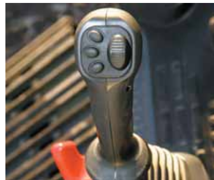
Joysticks met proportionele controleknop voor attachments
