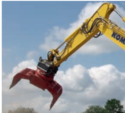
Twee optionele hydraulische leidingen waarop diverse hulpstukken gemonteerd kunnen worden
