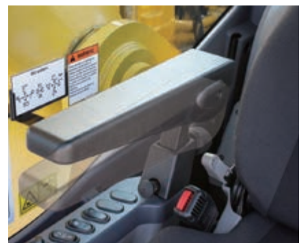
ArMLEUNING met eenvoudige hoogte-instelling
