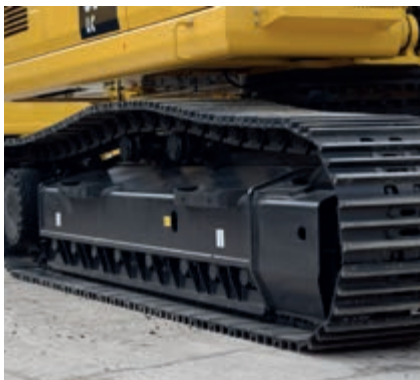
Onderrollen bescherming over de volledige rupslengte (optie)
