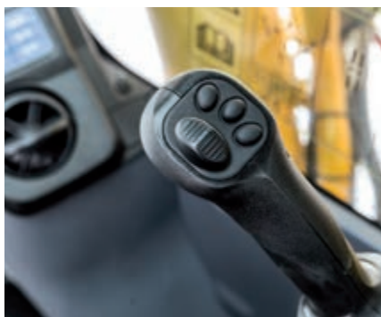
Praktische, ergonomische en precieze bediening dankzij de joysticks met proportionele bediening voor de uitrustingsstukken
