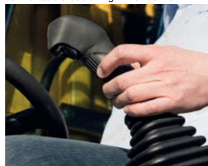
Dankzij de bediening via regelbare joysticks vereist de bediening van de machine minder inspanning, zelfs bij stuurintensieve werkzaamheden.
