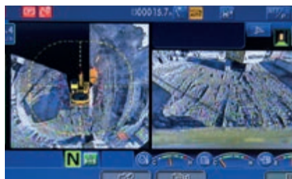
KomVision maakt het mogelijk om de machine steeds in "vogelperspectief" te zien dankzij de combinatie van verschillende camerahoeken
