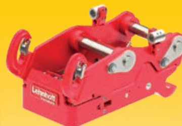
VL100 volhydraulische Variolock snelwissel De machinist kan de uitrustingsstukken, hydraulische aansluitingen inbegrepen, vanuit de cabine in enkele seconden wisselen zonder uit de cabine te komen en zonder extra personeel in te schakelen. Dat verhoogt de productiviteit en moedigt de machinist aan om voor elke taak het gepaste uitrustingsstuk te gebruiken. Het helpt ook om slangbreuk en vervuiling van het hydraulisch systeem of van de omgeving te voorkomen.
