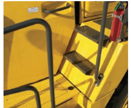
Veilig instappen in de cabine met een handgreep, buiten bereik van het potentieel gevaarlijke knikpunt
