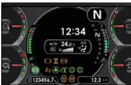
Informatie in één oogopslag: basisdashboard met LCD-monitor
