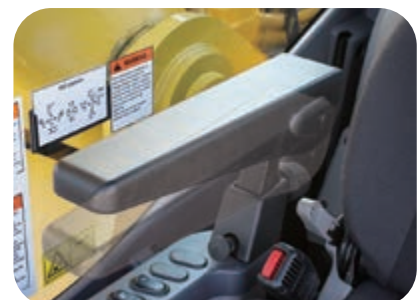
Armleuning met eenvoudige hoogte-instelling
