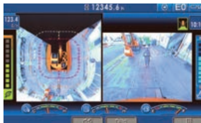
Via KomVision zijn verschillende camerazichten beschikbaar, maar met behoud van permanent "vogelperspectief" van boven de machine
