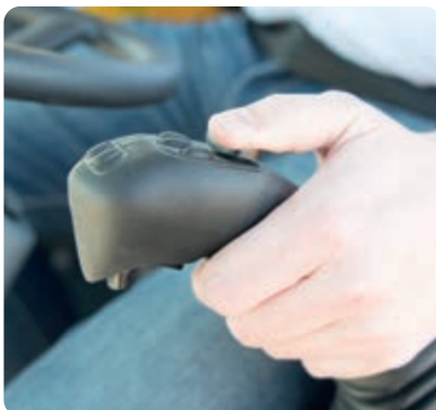
Ergonomische joysticks met proportionele controle
