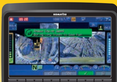
Eco-meter, eco-functie en brandstofmeter
