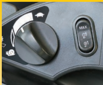
Bedieningsknop voor de variabele afstelling met het nieuwe kruipsnelheidsbereik (links) en schakelaar voor het variabele traction control system (rechts)
