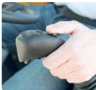
Manipulateurs ergonomiques avec commandes proportionnelles
