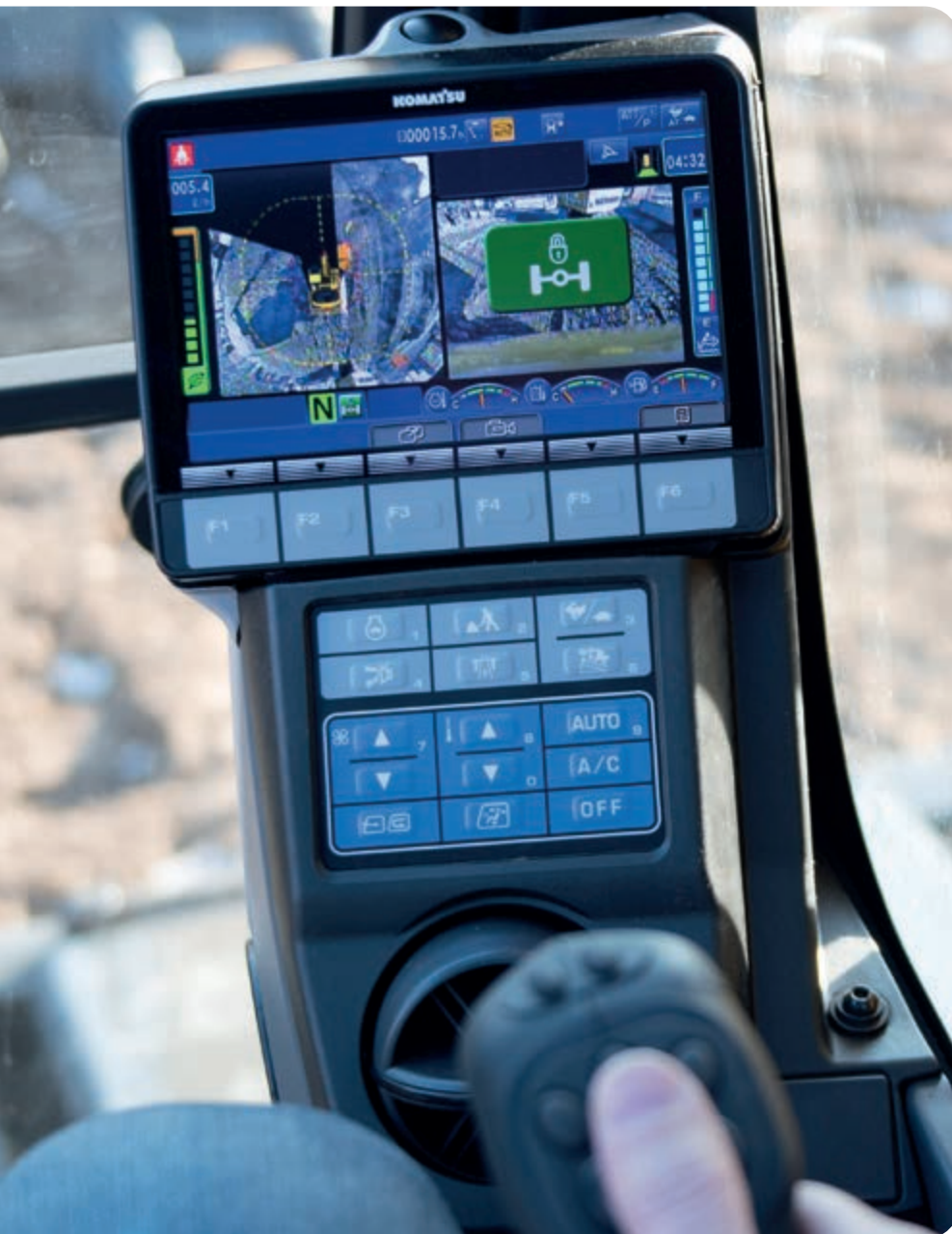
La machine dispose de raccords universels pour les accessoires tels qu'un BRH. Le passage à un mode basse pression n'exige qu'une pression sur le bouton de l'écran correspondant au mode BRH.
