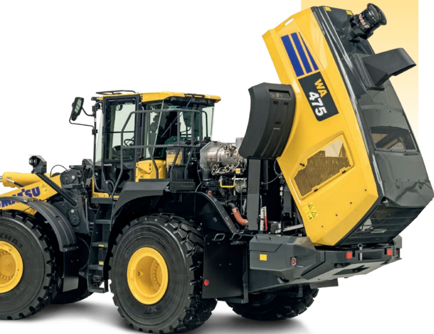
Des portes de service bien positionnées permettent un accès aisé et sûr aux points d'entretien quotidien
