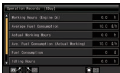
Un écran multifonctions affiche et contrôle de nombreuses informations d'utilisation et d'entretien
