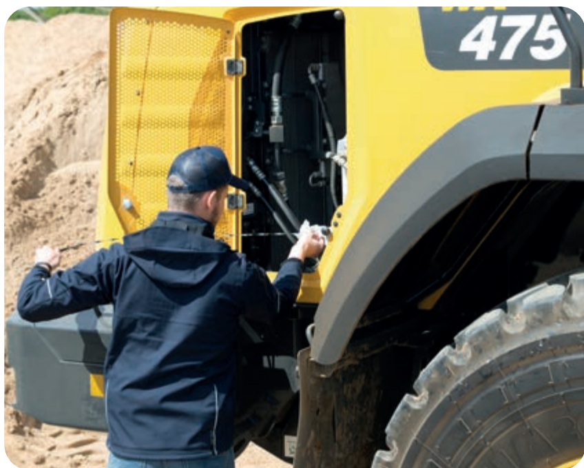
Des portes de service bien positionnées permettent un accès aisé et sûr aux points d'entretien quotidien
