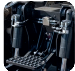
Blad- en stempelpootcilinders met ingebouwde terugslagklep (standaard)
