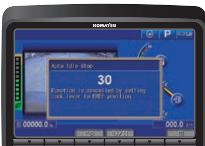
Eco-meter, eco-functie, een instelbare motorstop en de nieuwe automatische vrijloofunctie dragen allemaal bij tot een verdere afname van het brandstofverbruik
