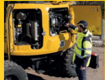
Alle belangrijke onderhoudspunten zijn goed bereikbaar vanaf de grond
