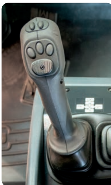
Multifunctionele PPC-hendel met optionele elektronische aansturing van 3de en 4de functie (EPC)
