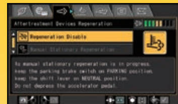
Écran de régénération du système de traitement des gaz d'échappement pour le filtre à particules diesel Komatsu (KDPF)
